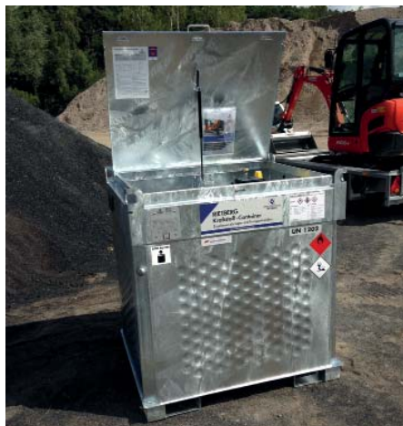
Zugelassene Behälter wie dieser „Quadro“ sind für alle zur mobilen Betankung erforderlichen Fahrten einsetzbar. (Foto: Rietberg)
