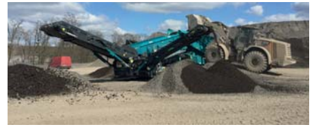
Die neue Powerscreen-Siebanlage Warrior 2100 Spaleck trennt selbst schwierigste Problemstoffe. (Foto: Christophel)
