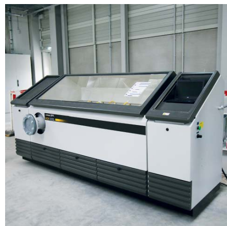
Salzsprühkabine zum Testen der Korrosionsbeständigkeit einzelner Bauteile
