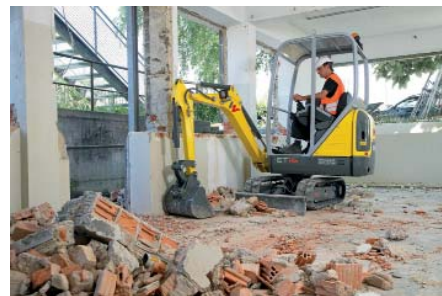
Mit seinem teleskopierbaren Fahrwerk eignet sich der neue Minibagger ET16 für schmale Durchfahrten und bietet gleichzeitig hohe Standsicherheit. (Foto: Wacker Neuson)
