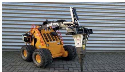
Die kleine Abrissmaschine ist elektrisch angetrieben kann per Fernsteuerung bedient werden. (Foto: Weber Maschinen und Fahrzeuge GmbH)
