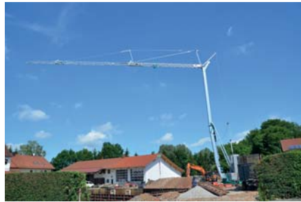
Der Schnellmontagekran CM 8254 hebt jetzt bis zu 4 t und bietet eine maximale Hakenhöhe von 21 m. (Foto: BKL)
