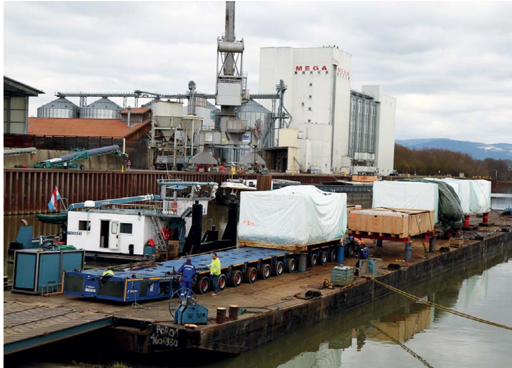
Mit dem Goldhofer-Selbstfahrer wurden die schweren Teile vom Ponton gefahren und anschließend auf die Schwerlastmodule umgeladen. (Fotos: Jens Hadel)
