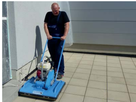
Beim Rollenrüttler VPR 700 ermöglicht die gleichmäßige Gewichtsverteilung auf vier PU-Rollen das schonende Abrütteln von großformatigen Platten. (Foto: Weber MT)
