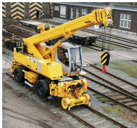
2-Wege Kran: Ein Sennebogen 643 wurde in Zusammenarbeit mit Dematec und Kuiken für Traglasten bis 17 t im Schieneinsatz konzipiert. (Foto: Sennebogen)
